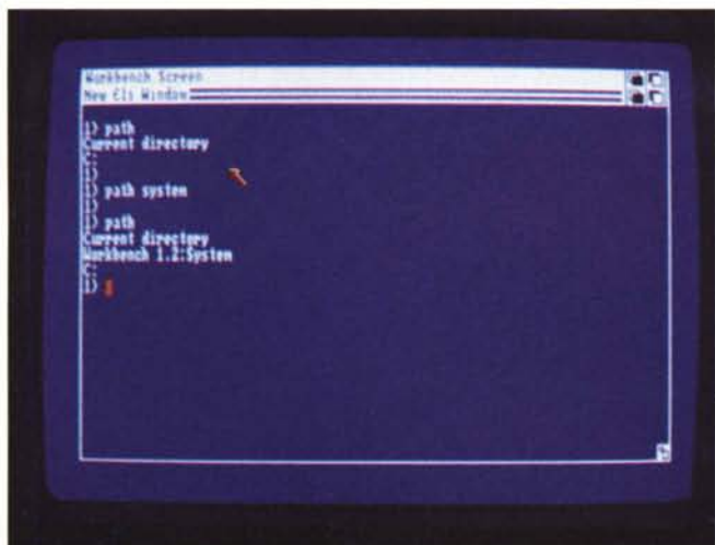
A sinistra il comando PATH. Inseriamo anche la directory SYSTEM nel percorso. A destra, la più simpatica System Request di Amiga. Con la release 1.2 abbiamo provato a togliere un dischetto dal drive mentre era in corso la lettura della directory. Con l'1.1 avrebbe dato un bel GURU MEDITATION.
