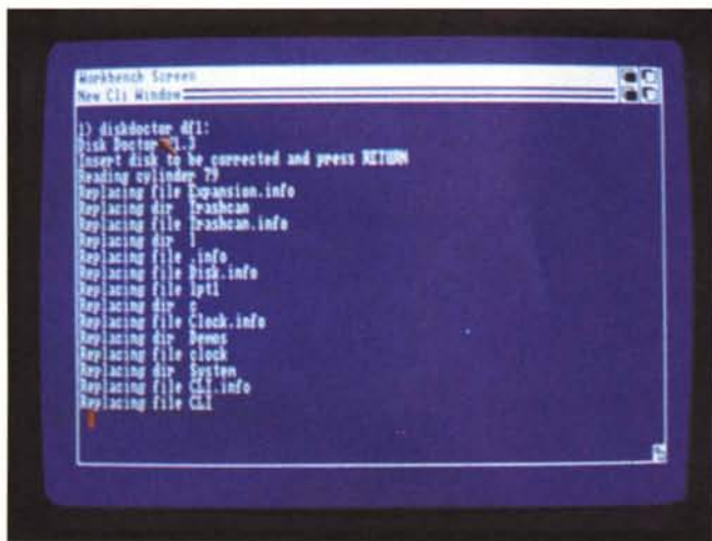
Due momenti di una riparazione dischetto a seguito del comando DISKDOCTOR.
