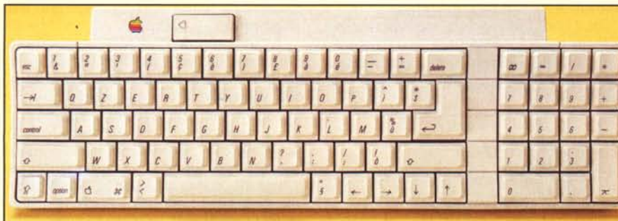
La tastiera dell'Apple IIGS, si collega alla CPU con un cordone flessibile tramite la porta Desk Top Bus.
