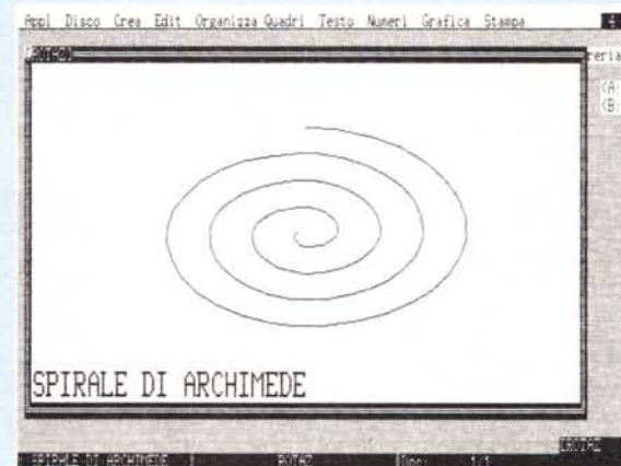
Figura 3 - Programma Grafico scritto in FRED Listato. Una evoluzione rispetto al programma precedente consiste nello scrivere un vero e proprio programma in cui vengano, all'interno di una struttura ciclica (@WILE...), calcolati e visualizzati elementi geometrici.
