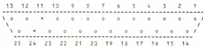
Figura 2 - Schema del connettore Cannon a 25 pin presente sul retro del PC e che consente la connessione ad una stampante con protocollo Centronics. I pin contraddistinti con un «*» possono essere cortocircuitati con un ponticello, secondo quanto detto nell'articolo.
