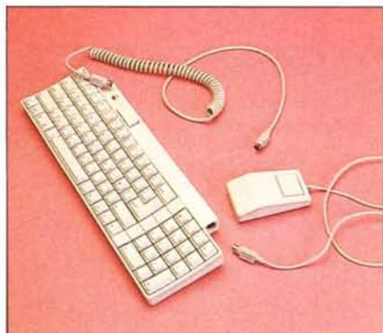
Il Mouse si collega in cascata alla tastiera sempre tramite il Desk Top Bus, la tastiera dispone di due ingressi/uscite equivalenti ai due angoli superiori, si può allora installare il mouse sia a destra che a sinistra. È possibile collegare fino a sedici tastiere in un unico Desk Top Bus, il mouse, se c'è, deve sempre essere l'ultimo.
