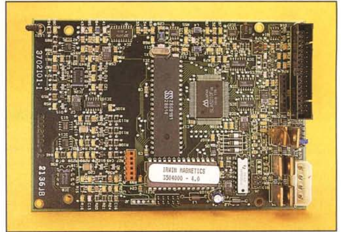
Le schede elettroniche a confronto: la scheda Memtec, più stretta e lunga, trova posto all'interno del PC; la scheda Irwin è connessa saldamente all'unità di back-up.
