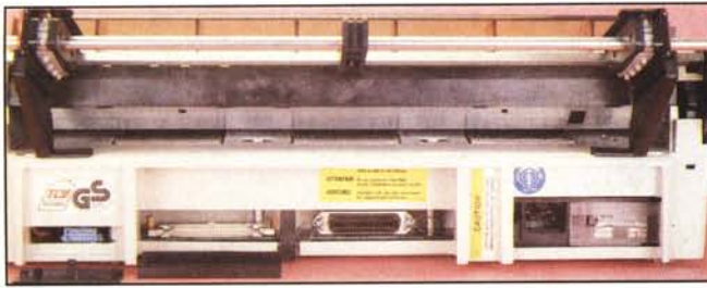
In alto il pannello posteriore ricco di connettori della Bitwriter MT 290; a destra la batteria di back-up che consente alla stampante di ricordare i parametri impostati dal pannello.
