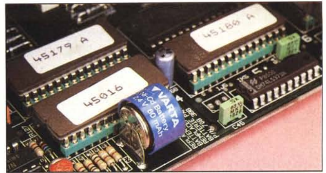
In alto il pannello posteriore ricco di connettori della Bitwriter MT 290; a destra la batteria di back-up che consente alla stampante di ricordare i parametri impostati dal pannello.
