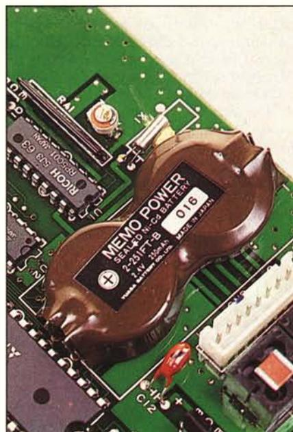
La batteria in tampone per l'orologio interno. È visibile il circuito integrato RP5C01.
