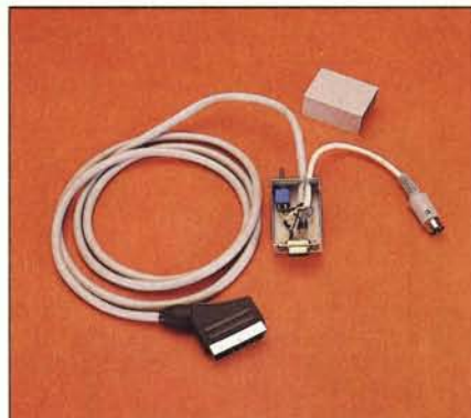
In queste tre foto si possono vedere i prototipi realizzati per i collegamenti video. A sinistra, i cavi per la connessione di un display monocromatico che permette di visualizzare 80 colonne (cavo di sinistra) oppure 40 colonne (cavo di destra). Al centro si può invece osservare il cavo con lo switch di selezione per commutare sullo stesso monitor 40 oppure 80 colonne. Infine, nella foto di destra è visibile il cavo per la visualizzazione di 40 oppure 80 colonne a colori rispettivamente in composito ed in RGB su monitor con presa SCART.
