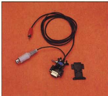
In queste tre foto si possono vedere i prototipi realizzati per i collegamenti video. A sinistra, i cavi per la connessione di un display monocromatico che permette di visualizzare 80 colonne (cavo di sinistra) oppure 40 colonne (cavo di destra). Al centro si può invece osservare il cavo con lo switch di selezione per commutare sullo stesso monitor 40 oppure 80 colonne. Infine, nella foto di destra è visibile il cavo per la visualizzazione di 40 oppure 80 colonne a colori rispettivamente in composito ed in RGB su monitor con presa SCART.
