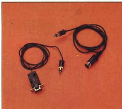
In queste tre foto si possono vedere i prototipi realizzati per i collegamenti video. A sinistra, i cavi per la connessione di un display monocromatico che permette di visualizzare 80 colonne (cavo di sinistra) oppure 40 colonne (cavo di destra). Al centro si può invece osservare il cavo con lo switch di selezione per commutare sullo stesso monitor 40 oppure 80 colonne. Infine, nella foto di destra è visibile il cavo per la visualizzazione di 40 oppure 80 colonne a colori rispettivamente in composito ed in RGB su monitor con presa SCART.
