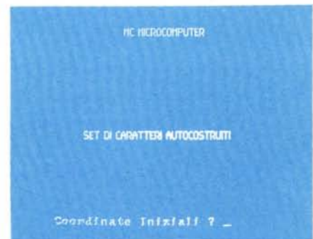
Figura 4 - Output del Programma Testo. Con una definizione di 320 pixel si possono ottenere al massimo sessanta caratteri per riga, riducendo il formato dei caratteri al limite della leggibilità.
