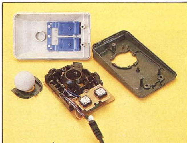
Foto 2 - Il Mouse smontato.
