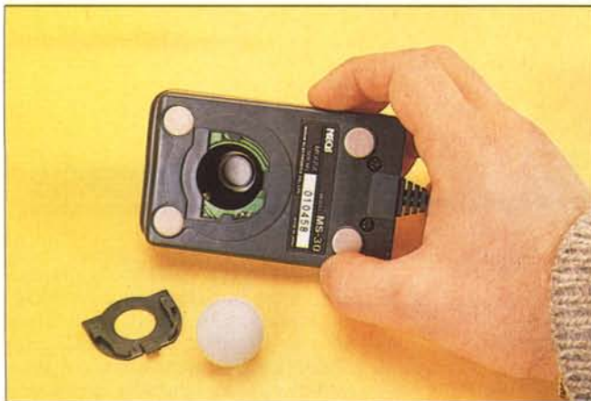
Foto 3 - Dalla finestra inferiore può essere rimossa la sferetta.
