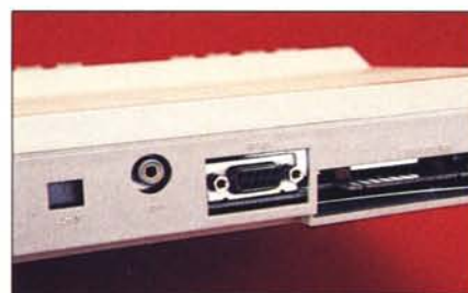
Un particolare del retro del C128 con il connettore RGBI.
