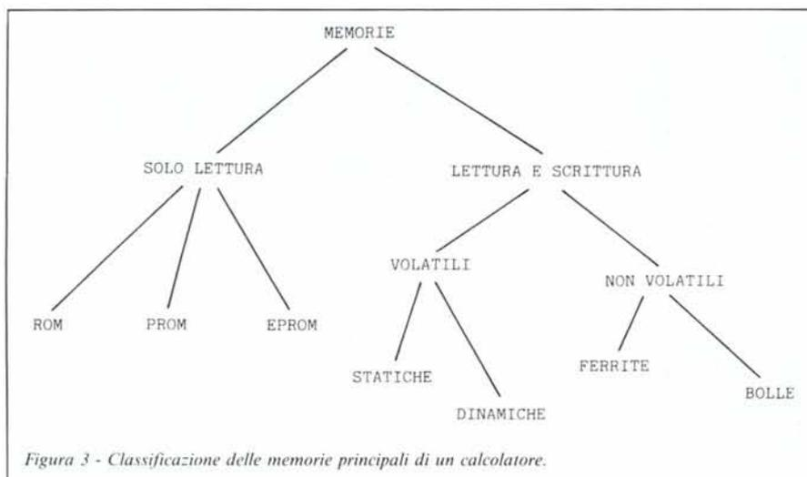
Figura 3 - Classificazione delle memorie principali di un calcolatore.
