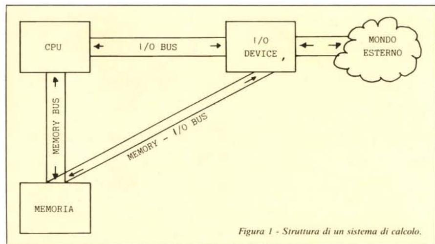
Figura 1 - Struttura di un sistema di calcolo.
