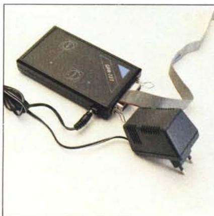
Foto 1 - Il buffer GPA 727 e il suo alimentatore. Quest'ultimo accessorio è opzionale in quanto, come nel Data Switch, la corrente di alimentazione può essere prelevata dalla stampante se essa è in grado di fornirne una quantità sufficiente. Questa opzione è abilitata in fase di montaggio. All'accensione, tenendo premuto il tasto "Pause", rilasciandolo e premendolo di nuovo viene stampata l'indicazione della capienza globale del buffer.
