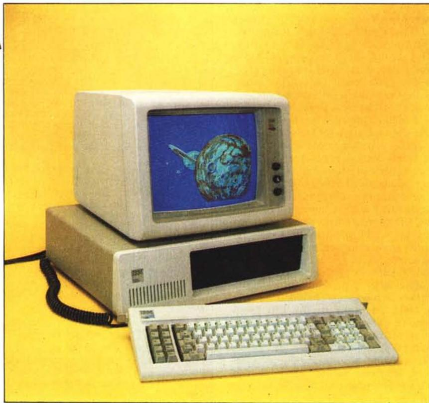
tiene il microprocessore (Intel 8088 con clock a 4,77 MHz), fino a 256 Kb di RAM, 40 Kb di ROM (comprendenti oltre al BIOS Basic Input/Output System anche il linguaggio BASIC interprete residente), uno o due DIP switch (a seconda del modello) a otto interruttori da settare in funzione della configurazione. Contiene inoltre uno zocchetto vuoto destinato all'installazione opzionale del coprocessore matematico.
