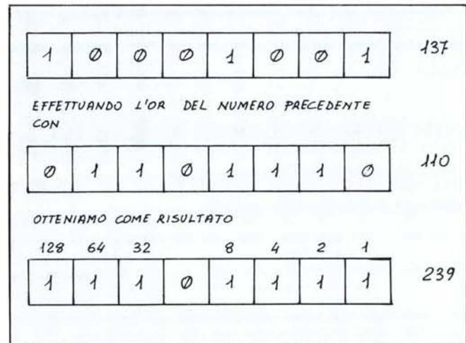
Figura 5 - Esempio di Or tra due numeri. Notate che si ottiene come risultato "1" quando almeno uno degli operandi è "1".
