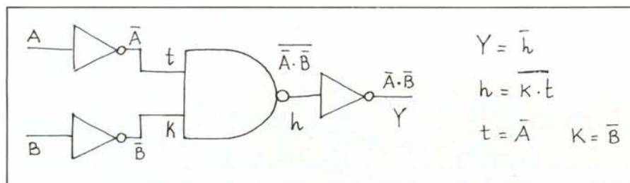
Figura 5 - Un metodo per ricavare un'espressione algebrica della funzione svolta da un circuito qualsiasi.
