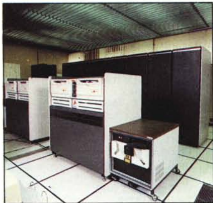
La sala hardware. Notare i due Digital PDP 11/70, mostrati anche nel particolare, con a fianco un'unità a nastro. Sul retro è visibile il TO-10 di teleoperazioni, che è in pratica l'unità che permette al computer di dialogare con i sistemi di controllo della linea, traslando opportunamente i vari segnali.
