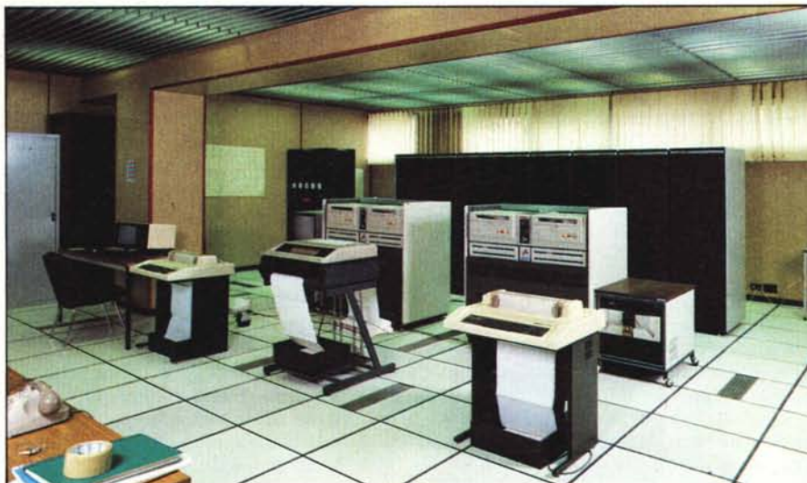
La sala hardware. Notare i due Digital PDP 11/70, mostrati anche nel particolare, con a fianco un'unità a nastro. Sul retro è visibile il TO-10 di teleoperazioni, che è in pratica l'unità che permette al computer di dialogare con i sistemi di controllo della linea, traslando opportunamente i vari segnali.
