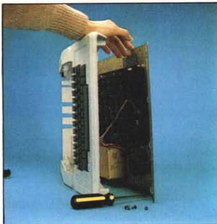
Per installare la tastiera occorre aprire l'Apple e, sfilato il cavo della vecchia tastiera, inserire al suo posto il circuito stampato fornito in dotazione con la MAK II. Il cavo della tastiera è equipaggiato di un passante in plastica che ne permette il fissaggio ad una delle feritoie che stanno sul retro dell'Apple.
