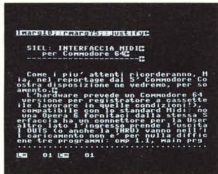
Un esempio di wordprocessor. Osservate il display a 37 caratteri per riga, nonostante le linee siano di 77 battute.
