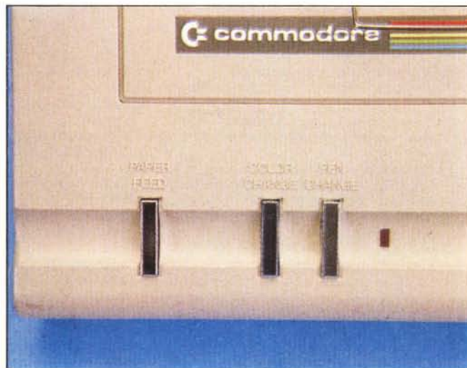
I tasti che controllano lo scorrimento della carta, il colore del tratto penna ed il posizionamento del carrellino per il cambio della penna.
