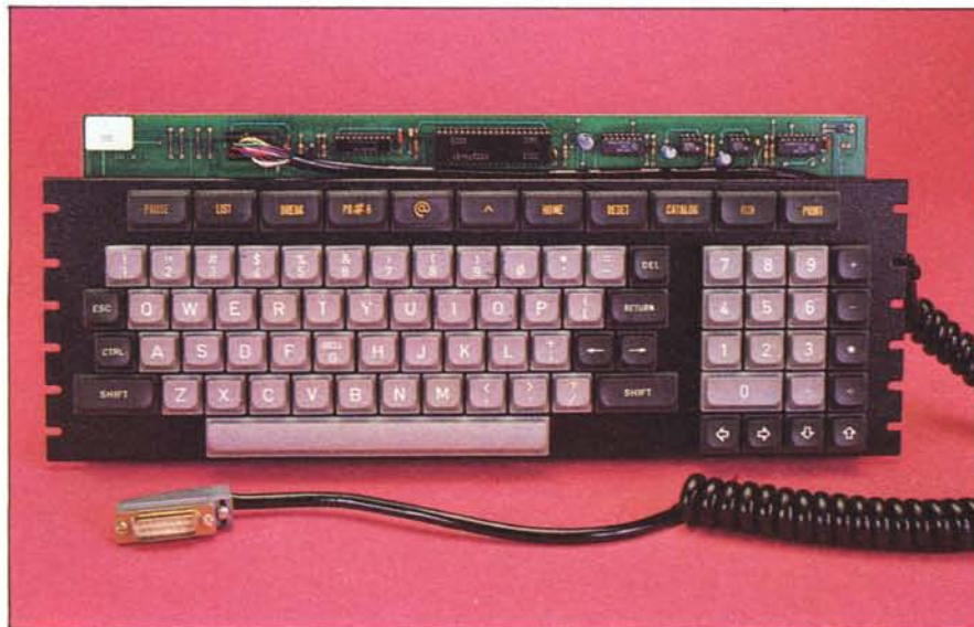
Tutta l'elettronica della tastiera è montata sulla stessa piastra dei tasti ed è gestita da un encoder appositamente realizzato.
