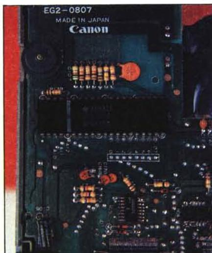
Il microprocessore NSC800 (CMOS Z-80 compatibile).
