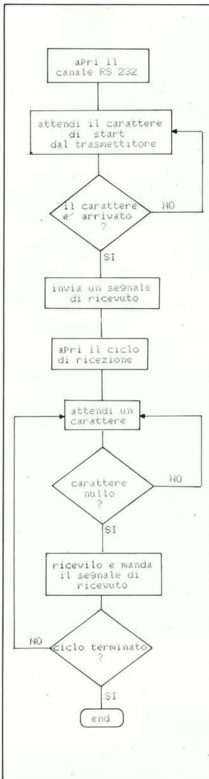
Figura 2 - Diagramma di flusso di una trasmissione sincronizzata con un carattere di controllo.
