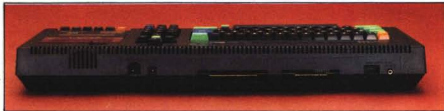
Le connessioni posteriori: da sinistra verso destra le prese sono di video, alimentazione, disco, stampante, joystick e audio.
