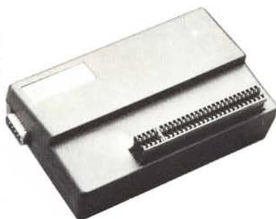
mette di registrare le istruzioni di programmazione per il joystick, in modo sequenziale e automatico, direttamente sul nastro prima del gioco che avrete scelto nella lista, così che caricando il gioco le volte successive, con interfaccia inserita, questa si programmerà automaticamente e non sarà necessario fare altre operazioni.
