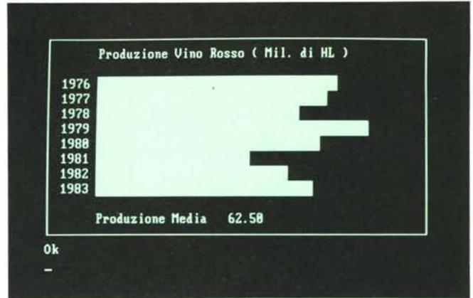
Figura 8 - Pagina 2 - Output su video. In fase di out le stringhe memorizzate vanno posizionate opportunamente sullo schermo, con la istruzione LOCATE.
