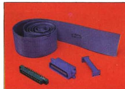
Foto 1 - Il cavo da 36 conduttori e i due connettori, uno per la stampante e l'altro per il 64, sono gli elementi-base del cavo. Per chi ha un minimo di esperienza il lavoro può essere completato da un cappellino plastico a coprire il connettore del 64, oppure da guaine termorestringenti intorno alle saldature.
