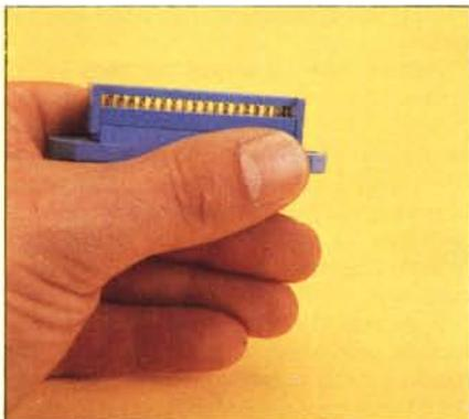
Foto 4 - Ecco come va disposto il connettore Centronics per poterli inserire il cavo.
