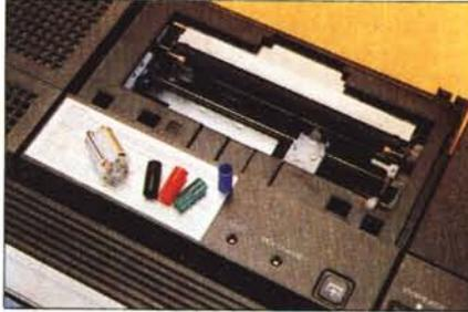
*Eccolo, carrozzato anche Sharp, il plotterino 40 colonne che esiste anche nella versione per Commodore, Casio etc.: in questo caso il tutto è più compatto, fattore caratteristico del computer.*
