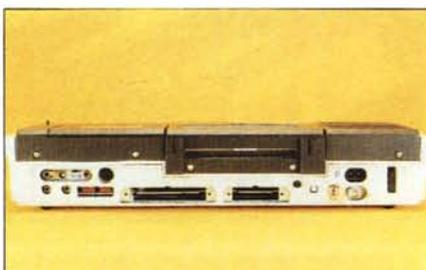
Pieno di connessioni, il retro del computer è un po' ingarbugliato: da sinistra a destra vediamo le prese video (in alto), il bus di espansione e quello della stampante esterna (all'acquisto protetti da coperture metalliche), il tasto di reset, la presa per l'alimentazione ed infine l'interruttore generale.
