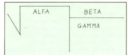
Figura 2 - Rappresentazione schematica dell'operazione di estrazione di radice quadrata del numero ALFA. Il risultato è BETA ed i calcoli intermedi si chiamano GAMMA.
