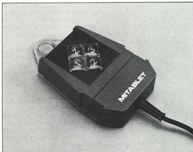
Figura 2 - Il tastierino del cursore del WATANABE DT 100. Premendo i tasti Z, 1, 2, 3 vengono trasmessi rispettivamente i valori 1, 2, 4, 8 utilizzabili via software.
