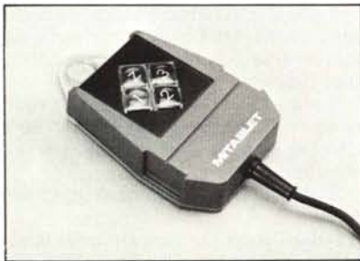
Particolare del cursore della Mitablot. Il tastierino ha quattro tasti 1,2,3, Z che producono i valori 1,2,4 e 8.
