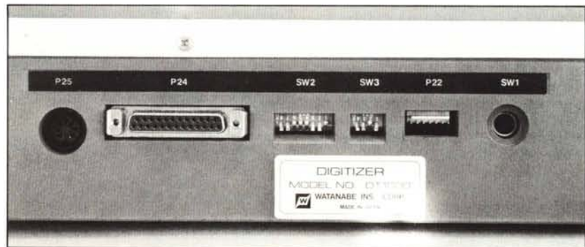
Particolare del lato posteriore della Mitablot. Qui sono alloggiati connessioni, switch, tasti, ecc.
