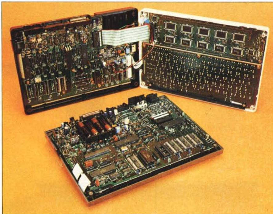
Panoramica delle due macchine aperte. In tutte e due i circuiti stampati sono tre: il computer vero e proprio, il display (intelligente con microprocessore e display driver) e la tastiera.
