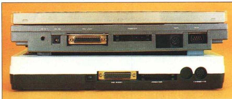
Sul retro delle due macchine si trovano i connettori per l'interfaccia parallela, l'RS232C, ed il registratore a cassetta. Inoltre sull'Olivetti c'è il connettore per il lettore di codici a barre e quello per l'alimentatore esterno. Sul TRS-80 questi due connettori si trovano sul lato sinistro e destro rispettivamente.
