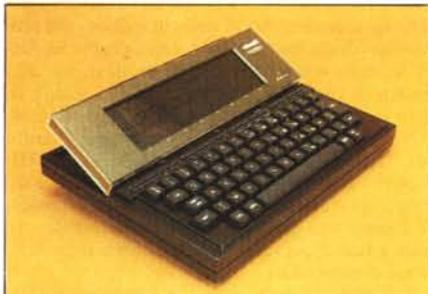
Il display dell'Olivetti M10 è inclinabile per una migliore visibilità nei casi in cui viene usato su una scrivania.
