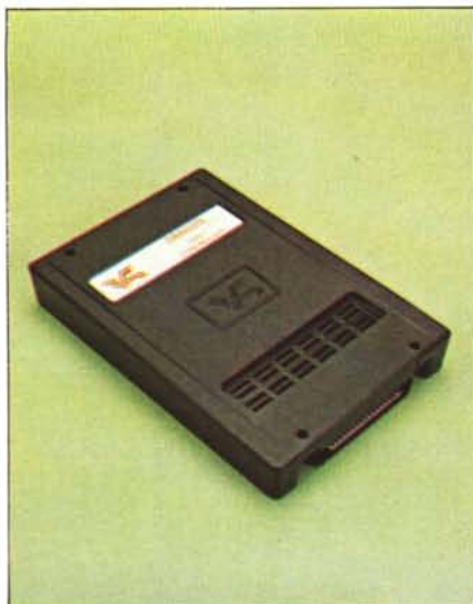
Subito in alto vedete la cartuccia del controllore di unità a disco: una sola ne gestisce fino a 4, in due mobili con due floppy driver ciascuno. A destra l'interno di un mobile contenente un driver singolo, ma con spazio per il secondo.
