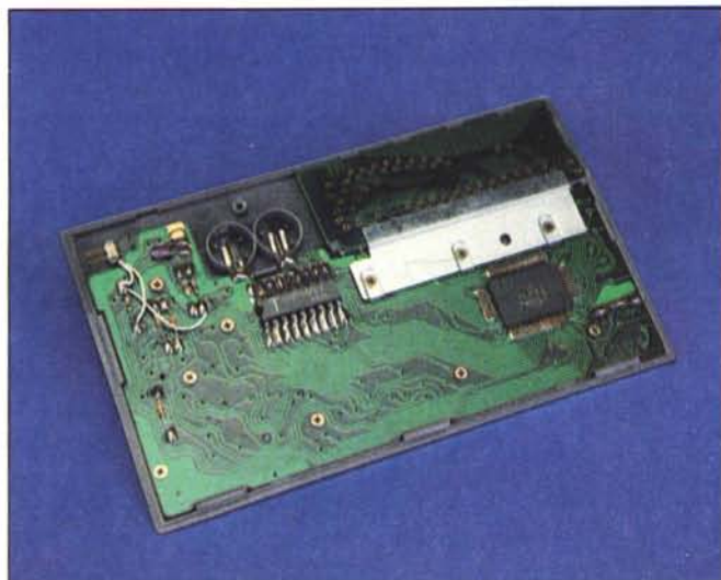
Sono rimasti solo due integrati e qualche componente discreto: che differenza con i modelli precedenti!
