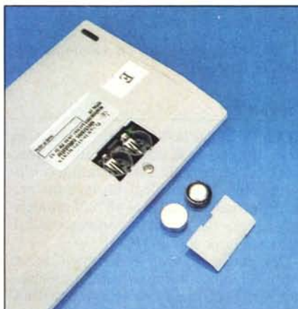
L'alimentazione è assicurata da due piccole pile, dato il bassissimo consumo.
