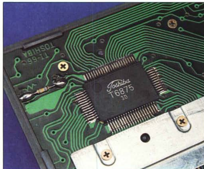
Questo è il cervello della TI 66 realizzato però dalla Toshiba.
