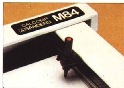
PORTA PENNE MOBILE. L'elettromagnete che comanda il PEN-UP PEN-DOWN è solidale con il portapenna stesso (holder). L'alimentazione avviene tramite la struttura metallica.
