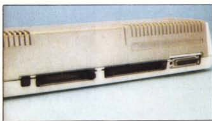
Particolare delle prese posteriori. Da sinistra a destra il tasto di reset, la Centronics, il bus per il DMA e la RS-232C.
