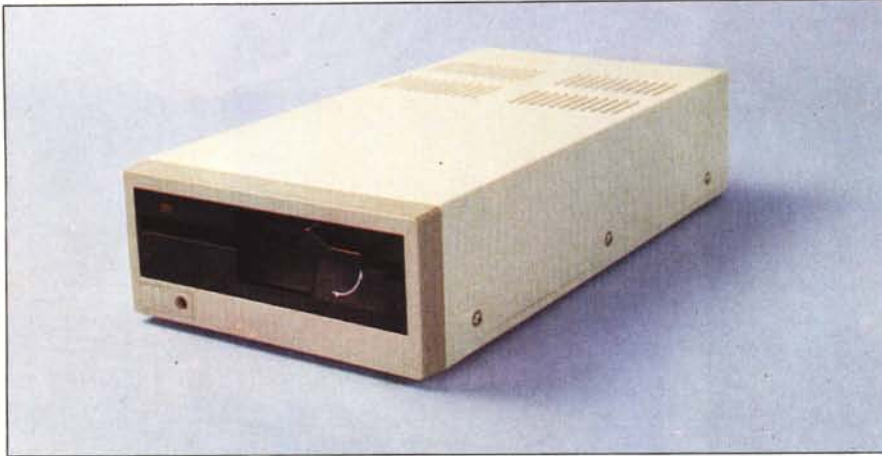
Il floppy disk slim-line, gradevole e pratico (lo si può sovrapporre ad un secondo senza problemi di spazio); dopo la formattazione ogni dischetto contiene 320 K byte.
