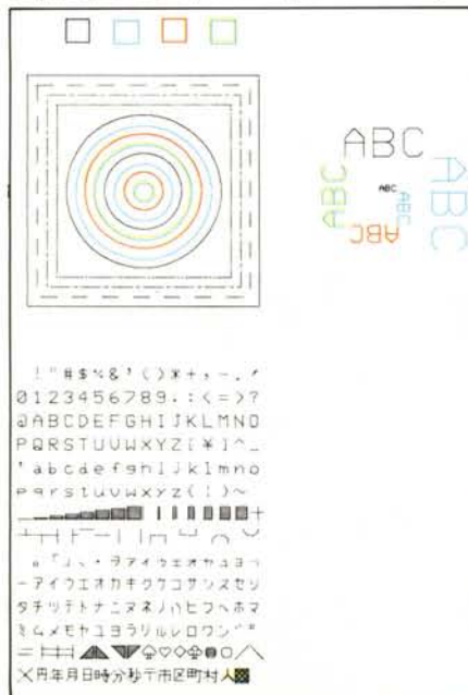
Fig. 5 - Output dell'auto-test eseguito dal miniplotter FP-1011
