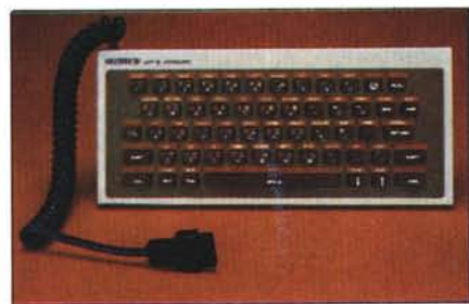
La full-size keyboard, tastiera di dimensioni normali: è realizzata con tasti di gomma (come lo Spectrum e l'Aquarius) di dimensioni sufficienti per poter contenere tutte le indicazioni relative alle funzioni multiple. Scomodi e fonte d'equivoci i tasti FIRE inopportunamente posti in luogo dei soliti SHIFT e RETURN, allineati più in alto. La casa ha annunciato una tastiera di tipo dattilografico.
