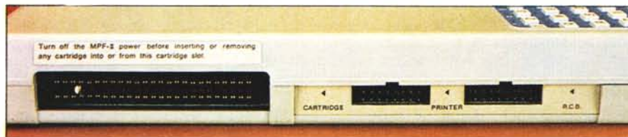
Le principali connessioni per periferiche. Da sinistra vediamo lo slot d'espansione, il connettore per stampante e subito dopo l'analogica fessura per la tastiera esterna o per il joystick.
