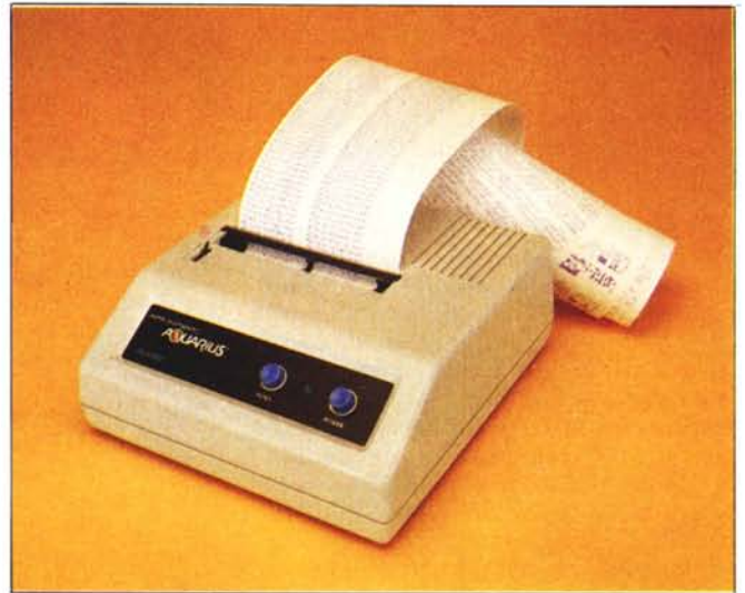
La stampantina tecnica dell'Aquarius. È da 40 colonne per riga, e stampa 80 caratteri al secondo. Va preparata al funzionamento con un PRINT CHR$(255).
