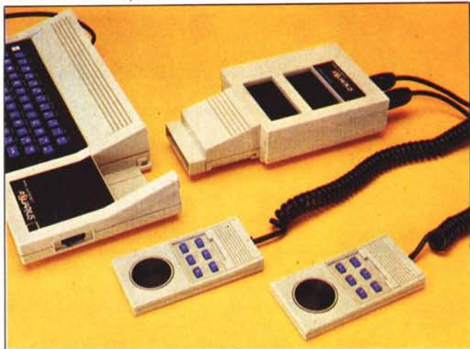
I joystick, del tipo dell'Intellivision (notare la piastra basculante) e la Mini Expander, sia inserita (foto a destra) che non (a sinistra).
