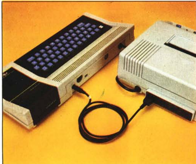
Connessione tra il computer e la stampante. Osservare la semplicità dell'operazione, affidata ad un solo cavo.
