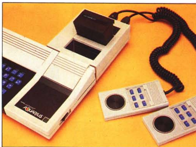
I joystick, del tipo dell'Intellivision (notare la piastra basculante) e la Mini Expander, sia inserita (foto a destra) che non (a sinistra).
