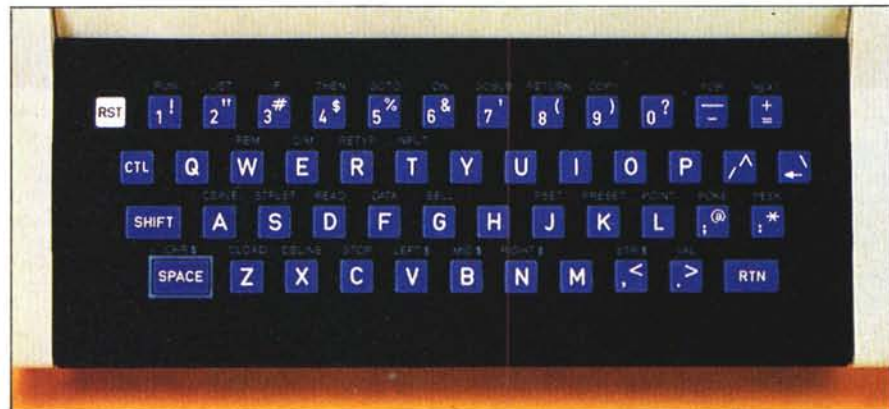
La tastiera dell'Aquarius: notare il tasto di reset (RST) separato dagli altri.
