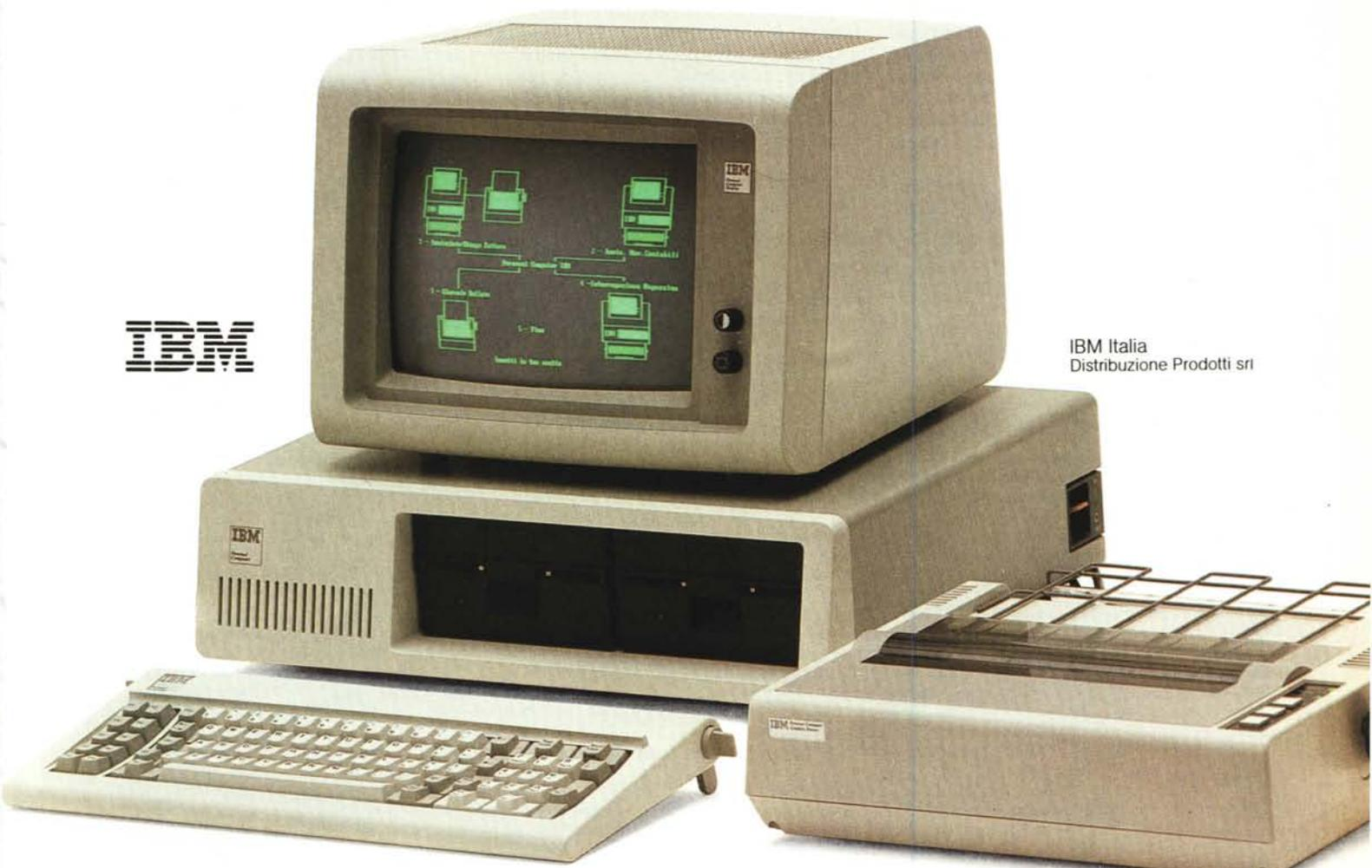
Il Personal Computer IBM contiene un microprocessore a 16 bit e una memoria di utilizzo che raggiunge i 640 Kbyte. E, grazie ai dischi fissi, la capacità massima di memoria del sistema è di 21 Mbyte in linea. Inoltre, puoi facilmente collegarti con un altro Personal Computer IBM, con elaboratori più potenti e con la rete dei Centri Servizi Elaborazione Dati della IBM.
