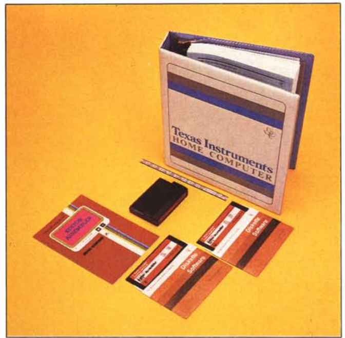
Il manuale dell'editor/assembler con il suo modulo, i due floppy e la nuova mascherina per la tastiera. Disponibile solo in inglese e non separatamente dagli altri componenti del compilatore.
