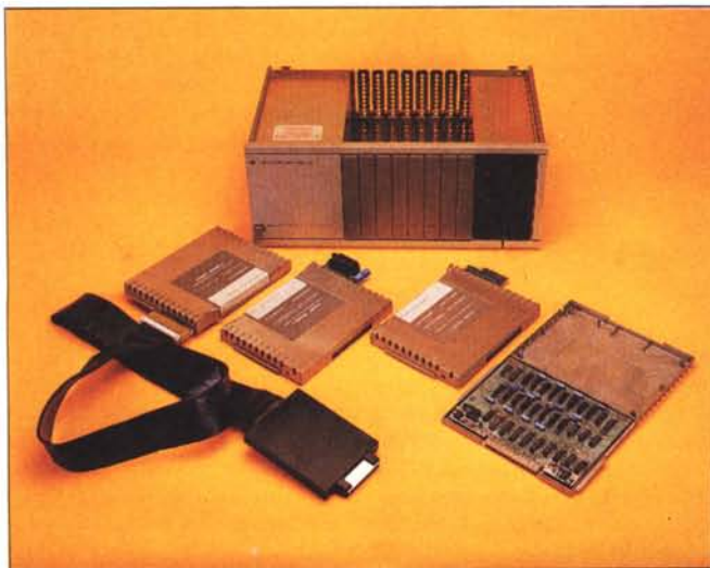
Il sistema di espansione nelle sue componenti. Da sinistra: scheda di interfaccia con la consolle, scheda RS232, disk controller e, aperta, la RAM da 32K. Sullo sfondo il rack che oltre a contenere le schede, fornisce loro l'alimentazione.
