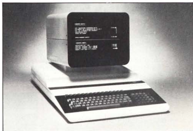
Due tipiche macchine appositamente concepite per consentire l'uso di CP/M o MP/M. La prima, americana, è l'Altos, caratterizzata da struttura tipo "Mainframe". La seconda è invece di progettazione e costruzione nazionale ed è il General Processor GPS-4. Entrambe, malgrado l'uso del microprocessore Z-80, consentono l'utilizzo di memorie di grandi dimensioni, oltre i 64K.
