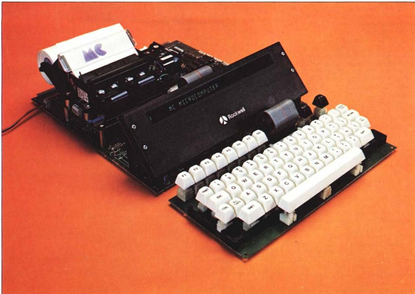
La scheda a microprocessore AIM 65/40, fabbricata dalla Rockwell International Corporation può essere considerata senza ombra di dubbio tra le migliori nel suo genere: ad una serie praticamente illimitata di possibilità in campo software unisce un assemblaggio hardware particolarmente curato e flessibile, arricchito dalla presenza di una stampante e di un display di caratteristiche notevoli. Ma andiamo con ordine.
