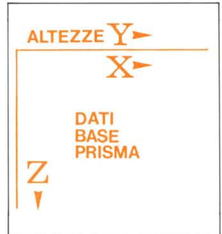
Figura 5 - Per l'input dei dati tridimensionali l'area del digitizer è divisa in due zone. La zona per l'input dei dati della base dove X = X_{dig} , Z = Y_{dig} , e zona input dati altezze; se Y_{dig} è minore di zero allora Y = X_{dig} .
