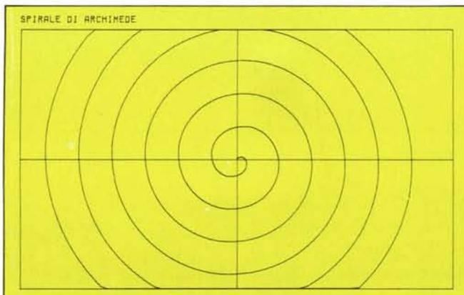
Figura 15 - PROGRAMMA SPIRALE DI ARCHIMEDE - Output. Il programma ha controlli di formato, per evitare la fuoriuscita del disegno dal bordo e controllo di fine, che interrompe l'esecuzione quando il raggio supera la dimensione della semidiagonale del formato di uscita.
