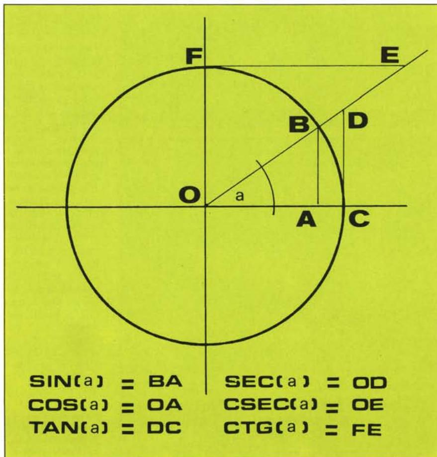
Figura 1 - IL CERCHIO TRIGONOMETRICO. Poiché il suo raggio è pari ad uno, i vari segmenti individuati danno il valore (grandezza adimensionale) delle varie funzioni trigonometriche.
