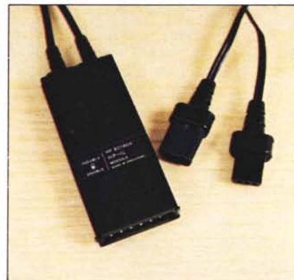
Modulo di interfaccia 82160A. Si notino i connettori HP-IL estremamente semplici e il commutatore che abilita o no le stampanti di nuovo tipo.
