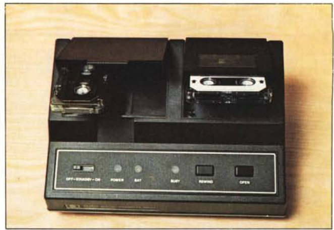
Sulla parte superiore del registratore 82161A sono ricavati il vano cassetta (a destra) e l'alloggiamento per due cassette di riserva (a sinistra).
