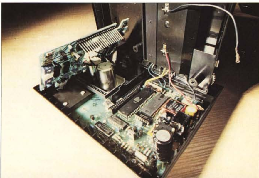
Vista interna del registratore. Si notino i due motori a trazione diretta per il movimento del nastro e il connettore a pettine per lo stampato delle funzioni "meccaniche". Il microprocessore utilizzato è del tipo 3870; la presenza di componenti discreti abbastanza contenuta.
