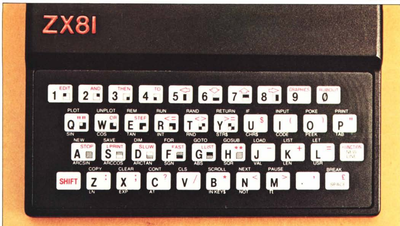
La tastiera è riprodotta, in questa foto, a grandezza pressoché naturale. È evidente che non si può pretendere, con il Sinclair, di digitare in modo particolarmente veloce. Si può notare, nella stessa foto, come ad ogni tasto corrisponda più di una funzione.
