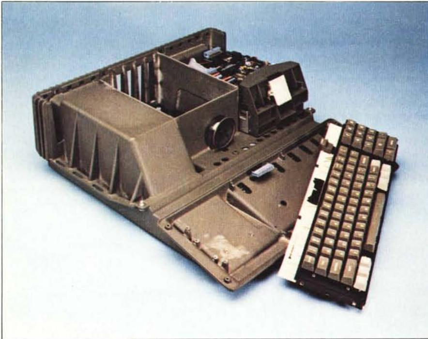
Meccanicamente l'Apple III è costituito da un unico pezzo di alluminio pressofuso nel quale si incastra perfettamente la tastiera, il drive, l'alimentatore etc. È quindi molto robusto e l'alluminio serve per disperdere l'inevitabile calore prodotto dall'elettronica e dall'alimentatore. Da notare inoltre che non è stato necessario includere una ventola.
