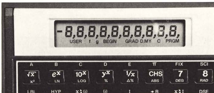
Il display della 11C tutto acceso: la presenza di simboli usati nelle calcolatrici finanziarie (BEGIN, D.M.Y., C) fa supporre che si tratti dello stesso display utilizzato per la 12 C.
